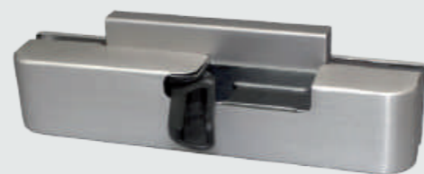
Türdämpfer Mute Selbstschließende Einzugsdämpfung für Drehtüren. Zufallende Türen werden gedämpft und sanft in die Endlage gezogen.
