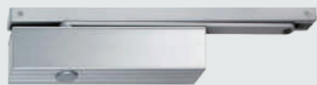
TS 61 Türschließer mit Gleitschiene mit stufenloser Schließkräfteinrichtung, 2 - 5 nach EN 1154 A ■; Korpus in silber matt, mit Kappe in Edelstahl matt
