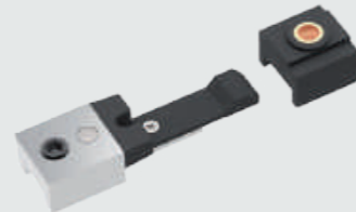
Zubehörset FKL-E Einstellbare Federrostklemmung für Gleitschiene B, mit integriertem Anschlagpuffer. Offenhaltungswinkel einstellbar von 70- 130°, nicht überfahrbar.
